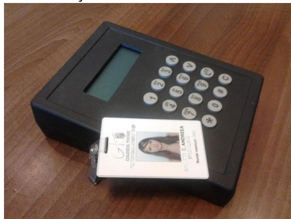
Dispozitiv de notare și pontaj a elevilor în sălile de clasă CATALOG-PROXA-MF485
